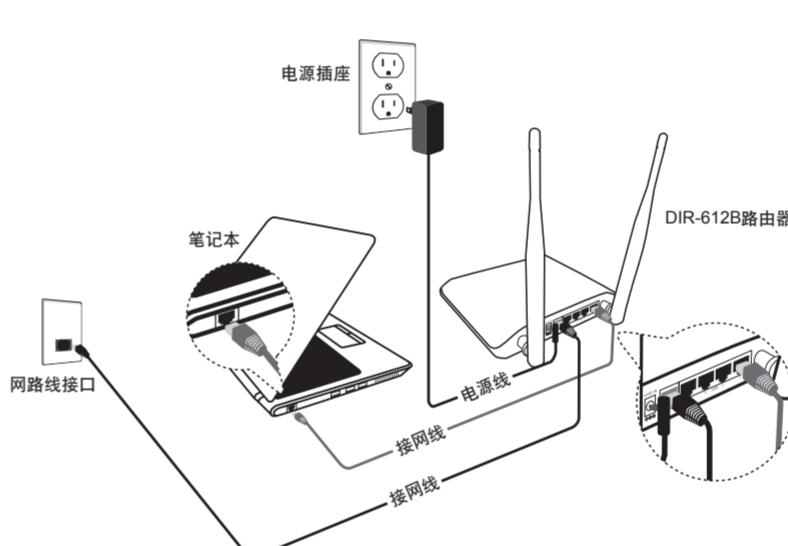
接线后请确认DIR-612B的电源指示灯亮起
