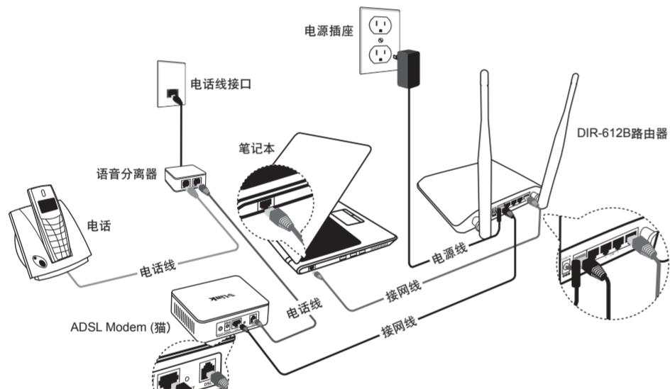
接线后请确认DIR-612B的电源指示灯亮起
